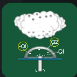
Cuando la diferencia de potencial interna entre placas del condensador supera el valor umbral el dieléctrico se transforma en conductor, produciéndose la descarga del condensador y quedando la zona externa del inhibidor cargada positivamente.
